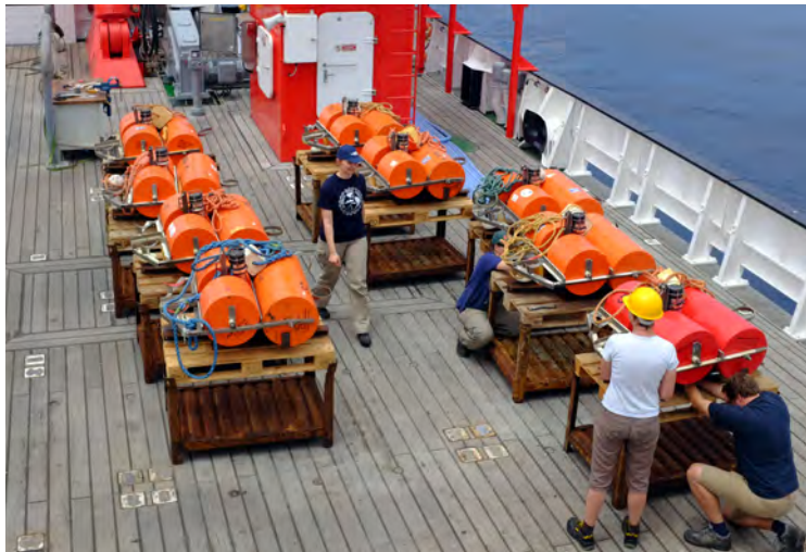
Ozeanbodenseismometer werden auf dem Arbeitsdeck des FS SONNE für einen 6-monatigen Einsatz vorbereitet. Die Geräte sollen die Erdbebenaktivität an der chilenischen Plattengrenze registrieren.
