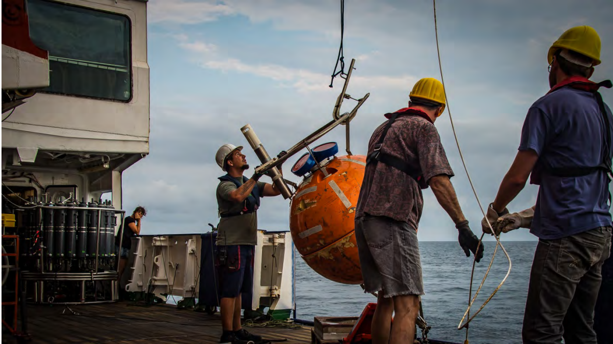
Fig. 2: Recuperação do elemento de topo, incluindo o perfilador acústico Doppler de corrente do Mooring da corrente de Angola aos 11 ° S (Foto: SVN).
