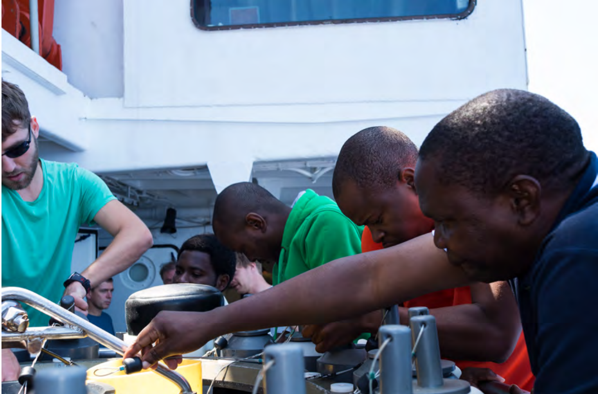
Abb. 2: Die Arbeiten beginnen immer mit einer Einweisung in die verschiedenen Instrumente, hier die Vorbereitung der CTD-Sonde auf die Stationsmessungen (Foto: SvN).
