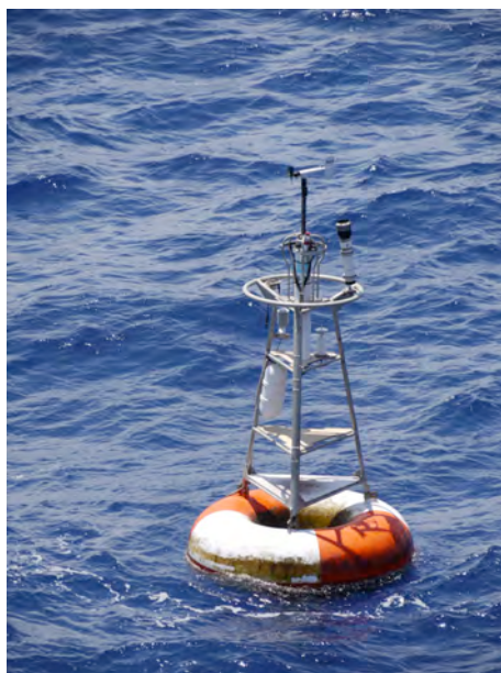
Die französische PIRATA Boje bei 10°S und 10°W misst meteorologische und ozeanographische Parameter und überträgt diese in Echtzeit.
